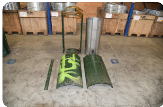
1 De afvalbak wordt gedemonteerd. 95% van de onderdelen is direct herbruikbaar.
