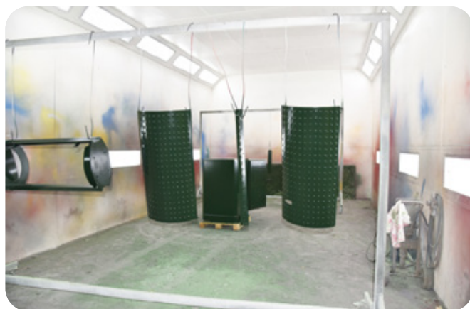
2 Onderdelen worden opgeknapt, gestraald en voorzien van een nieuwe poedercoating.
